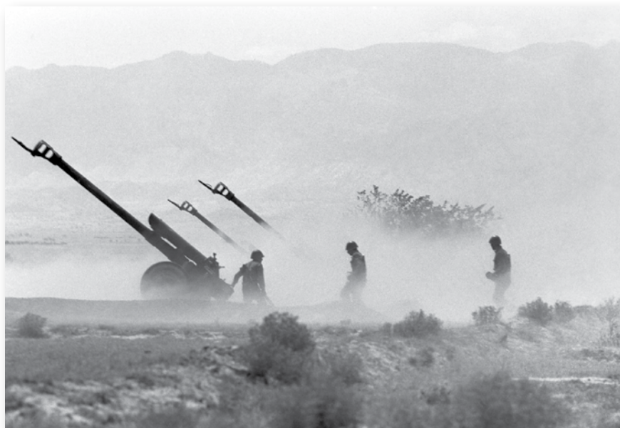
ADR pajėgos šaudė iš 122 mm kalibro sovietinių haubicų D-30. Tai buvo patikimas ginklas, kurio šaudymo nuotolis viršijo 15 kilometrų. Per visą Afganistano karo laikotarpį šiuos pabūklus naudojo ir ADR kariuomenė, ir sovietai. (ITAR-TASS / Viktor Budan via Getty Images)
