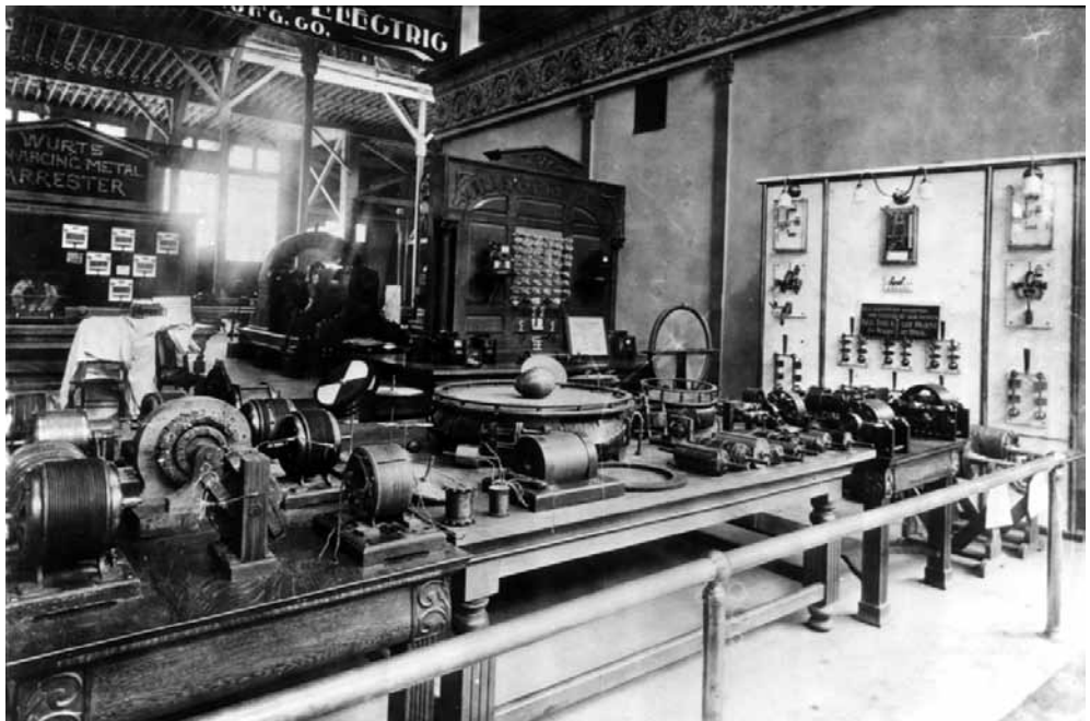
„Westinghouse Electric Corporation“ elektrinių variklių, pagamintų pagal N. Teslos patentą, standas 1893 m. pasaulinėje parodoje Čikagoje, Iliojaus valstijoje. Demonstruojama, kaip jie veikia. Priekyje eksponuojami ankstyvieji Teslos transformatoriai ir jo aukšto dažnio kintamosios srovės generatoriaus dalys.
